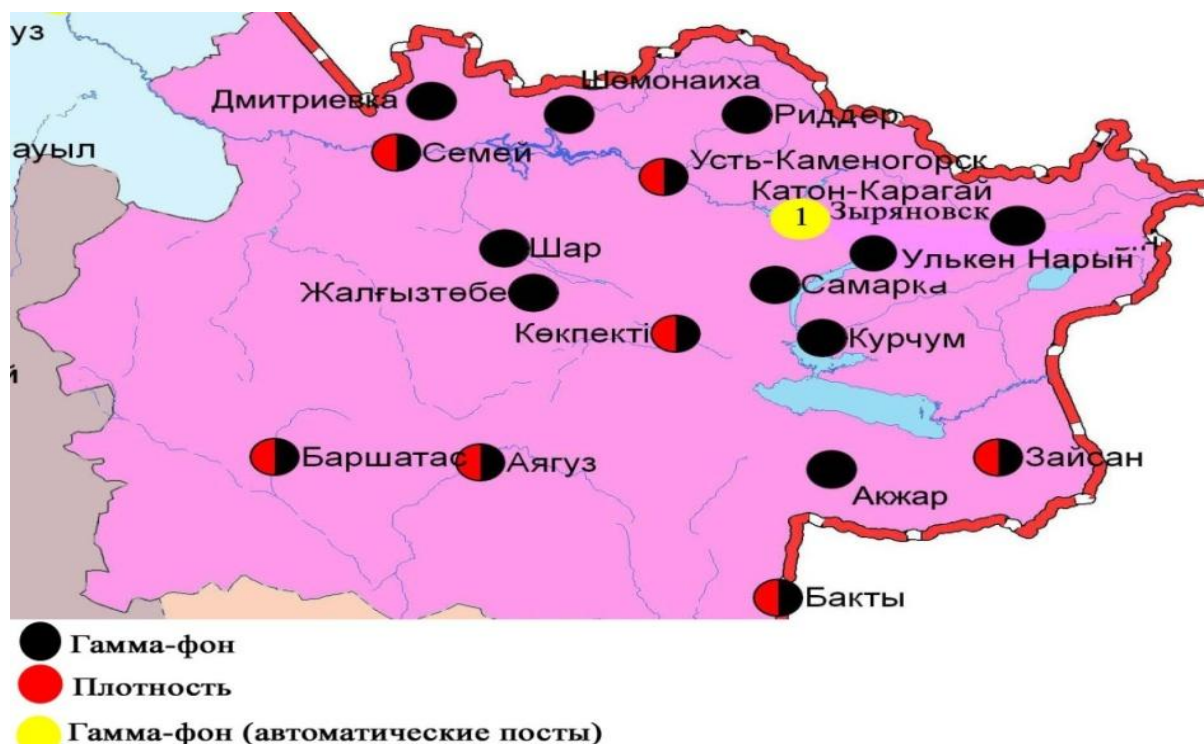
Рис. 5.9 Схема расположения метеостанций за наблюдением уровня радиационного гамма-фона и плотности радиоактивных выпадений на территории Восточно-Казахстанской области
