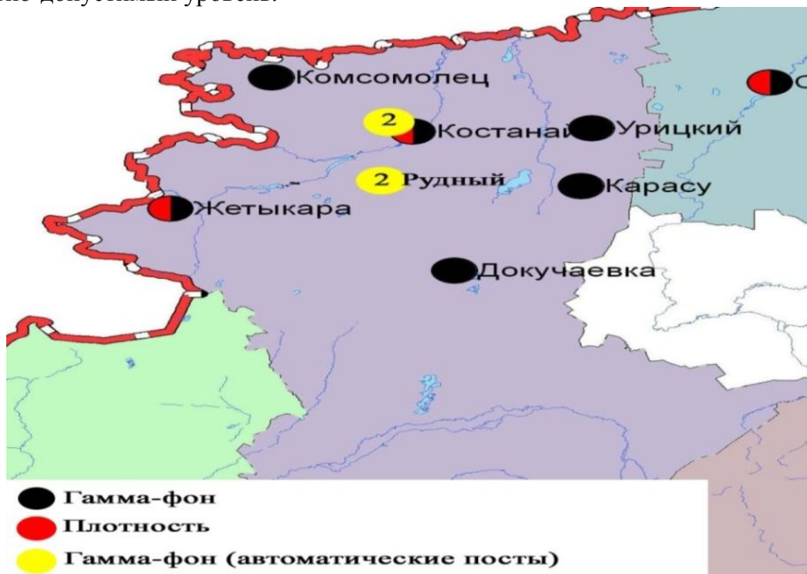
Рис. 9.6 Схема расположения метеостанций за наблюдением уровня радиационного гамма-фона и плотности радиоактивных выпадений на территории Костанайской области
